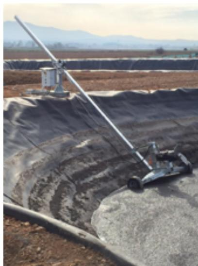
**SOPORTE CON RUEDAS "JET" PARA BALSAS CON TALUD**
